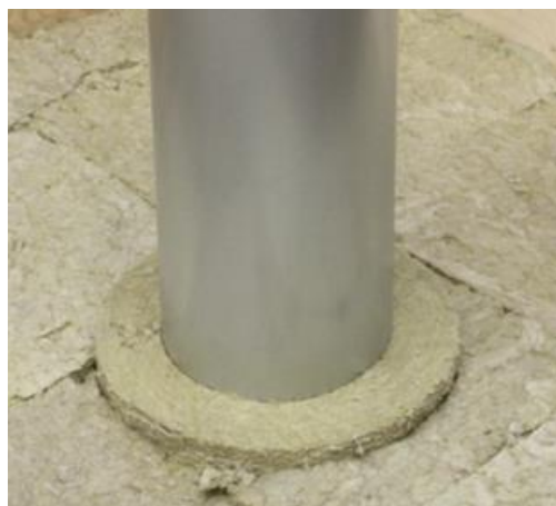
Kuvat 1 ja 2: Vasemmalla Koe 1 (eristepaksuus 200 mm). Oikealla lisä-eristetty läpivienti avoimella metallilieriöllä.
