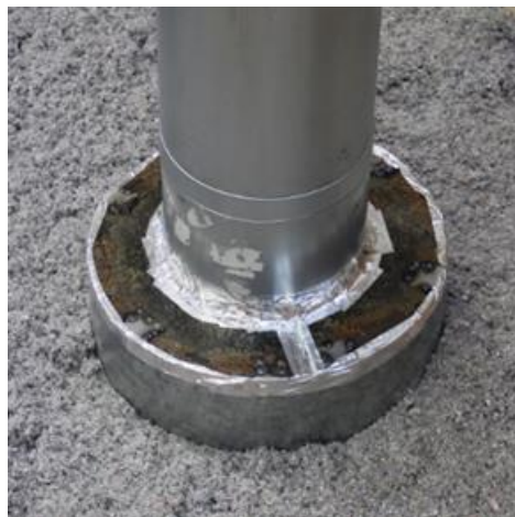
Kuvat 3 ja 4: Vasemmalla kokeen 3 tiiviisti suljettu kansirakenne. Oikealla kokeen 4 osittain tuulettuvalla kauluksella suljettu rakenne.
