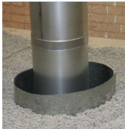
Kuvat 1 ja 2: Vasemmalla Koe 1 (eristepaksuus 200 mm). Oikealla lisä-eristetty läpivienti avoimella metallilieriöllä.
