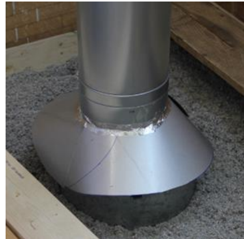
Kuvat 3 ja 4: Vasemmalla kokeen 3 tiiviisti suljettu kansirakenne. Oikealla kokeen 4 osittain tuulettuvalla kauluksella suljettu rakenne.
